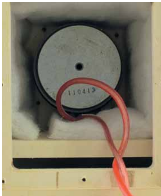
Particolare del generoso magnete del woofer da 3 pollici, cono in ALUM/MG con sospensione in SANTOPRENE, bello il cestello presso fuso; da notare l'accordo anteriore della linea di trasmissione di sezione bassa e allungata.
