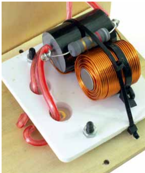
Particolare del crossover.
