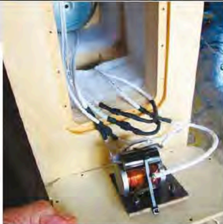
I componenti del crossover sono montati su una basetta antirisonante. Si tratta di filtri del primo ordine, bobina con nucleo sul woofer e condensatore da 3,9 \mu\text{F}/400 \text{ V} più resistore da 3,9 \text{ ohm}/10 \text{ W} in serie all'efficiente tweeter. Nella cavità della cassa si vede anche l'apertura quadrata di comunicazione fra le due 'camere' superiore e inferiore.
