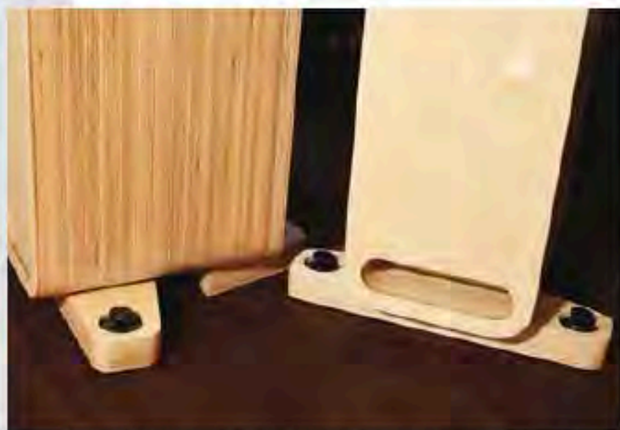
Le basi, sempre in strati di betulla pressati, si avvitano sotto e sono dotate di punte comodamente regolabili da sopra grazie alla testa a ghiera grande.
