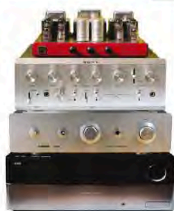
Le amplificazioni. Dall'alto gli integrati Synthesis DL1 (4+4 EL84), il Sony TA-1130 usato solo nella sezione finale di potenza, il Sugden A215E e il ricevitore multicanale Harman/Kardon AVR165.
