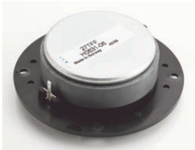
Il tweeter ha la cupola morbida da 27 millimetri ed un notevole complesso magnetico in ferrite. Capace di una risposta lineare e di una grinta notevole, va solo ammorbidito in gamma media, esattamente come ha fatto il progettista.
