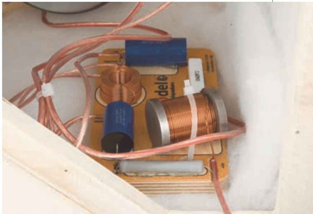
Il filtro crossover utilizza una componentistica di ottimo livello. I condensatori MKT sono costruiti dalla Jantzen Audio così come le induttanze, il cui filo è incollato spira per spira. Quella in primo piano è l'induttanza da 3 mH in serie al woofer e dotata di supporto di polveri di ferro.
